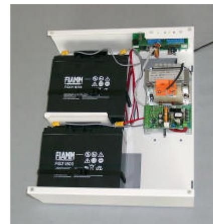
Foto 2 – Vista frontale con batterie e alimentatore posizionati.
