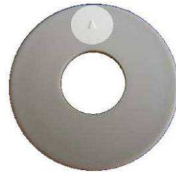
Figura 15: Diaframma esterno con il suo triangolo inciso
