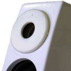
Figura 14: Diaframma posizionato davanti al Ricevitore del blocco ottico
