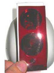
Fig. 11: Collocamento del filtro di simulazione allarme incendio
